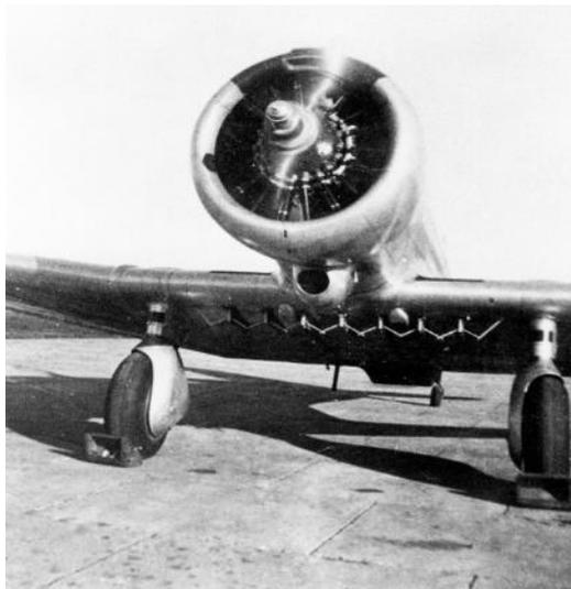
El 8 A2 probando motor en punto fijo. Observar el sistema de capacidad portante de bombas en primer plano, implicando una labor importante para el servicio de armamentos.
